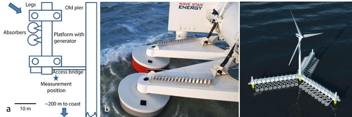
Figura 2.15: Representação do dispositivo Wave Star. Adaptado de (Ahmed et al., 2023; Wave Star – Unlimited Clean Energy, [s.d.]).
