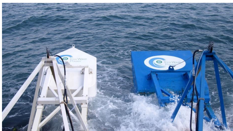
Figura 2.14: Representação dos dispositivos Power Wing e Wave Clapper. Adaptado de ( Eco Wave Power - Wave Energy Company , [s.d.]).
