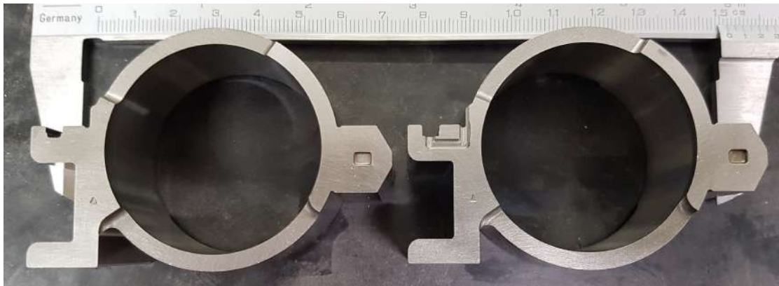
Figura 5.6: Anel com e sem modificação de transporte de óleo (canal).
