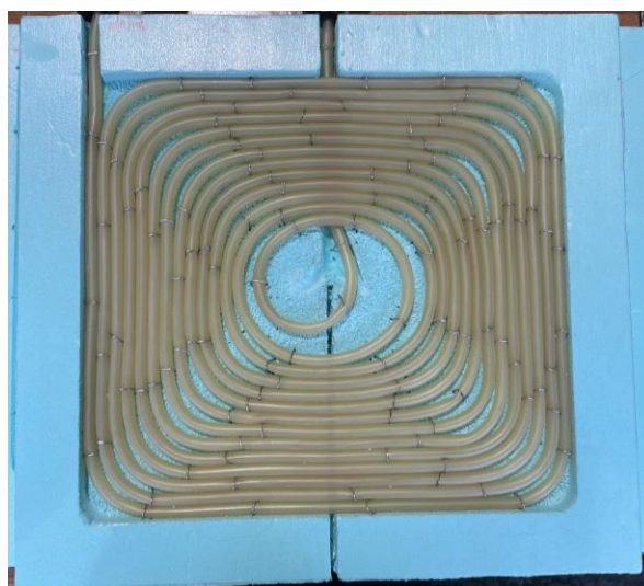
Figura 34. Disposição do tubo no interior do molde superior de XPS, para a placa de HDPE.
