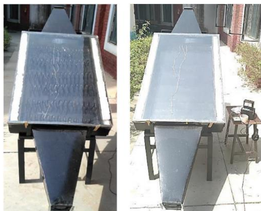
Figura 16: Aquecedor solar de ar com (SAH-C) e sem (SAH-A) os tubos helicoidais [59].
