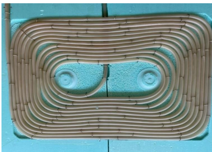
Figura 33. Disposição do tubo no interior do molde superior de XPS, para a placa de alumínio.
