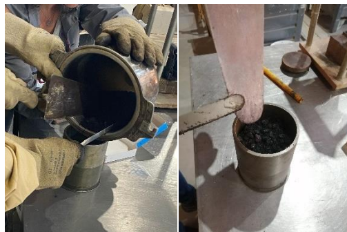
Figura 15 - Colocação da mistura em moldes.
