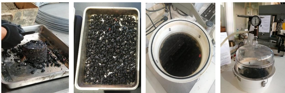
Figura 20 - Determinação da baridade máxima teórica com o picnómetro de vácuo.
