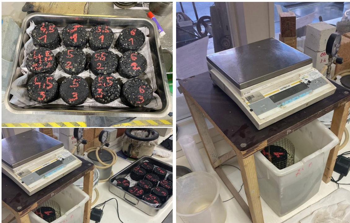
Figura 18 - Preparação e pesagem dos provetes Marshall.
