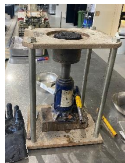
Figura 17 - Desmoldagem da mistura.
