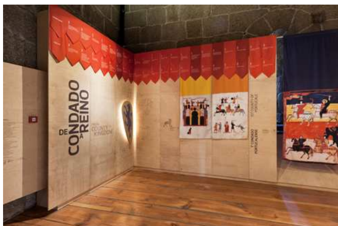
Pormenor de sistema expositivo com apanelado autoportante de bétula impresso que permitiu criar o ambiente cenográfico garantindo a preservação da preexistência arquitetónica (2017, fotografia de Luís Ferreira Alves©).
