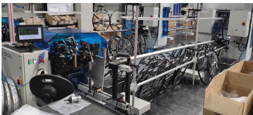
Figura 3.7: Zona de enraiamento das rodas
