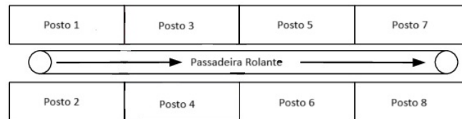
Figura 2.3: Esquema representativo da linha de montagem lado a lado
