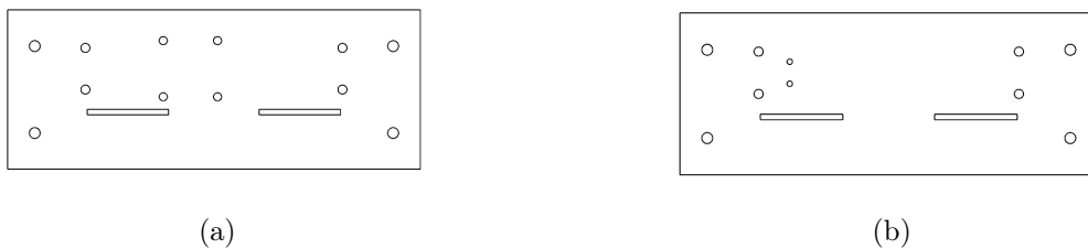
Figura 3.12: Parede onde será colocado: (a) - o motor NEMA; (b) - a polia.
