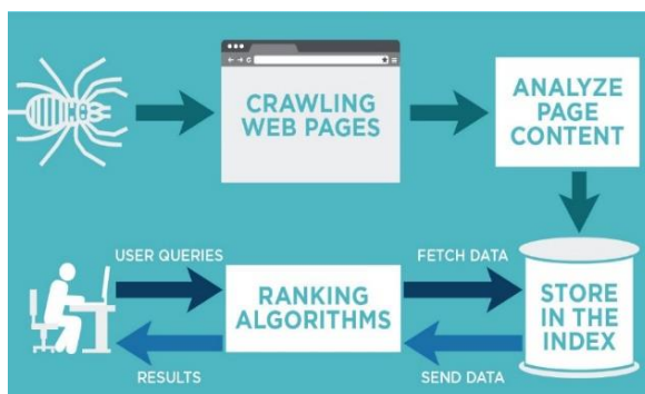
Figura 14: Esquema do processo de Crawling , Indexing e Ranking dos Search Engines . Retirado de Bergeron (2019).
