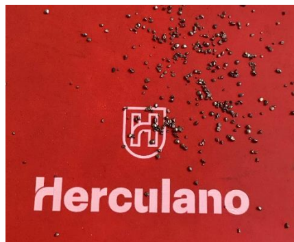
Figura 20 - Granalha usada no processo de decapagem
