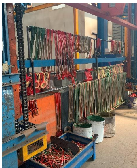
Figura 38 - Estrutura de suporte para ganchos aplicada
