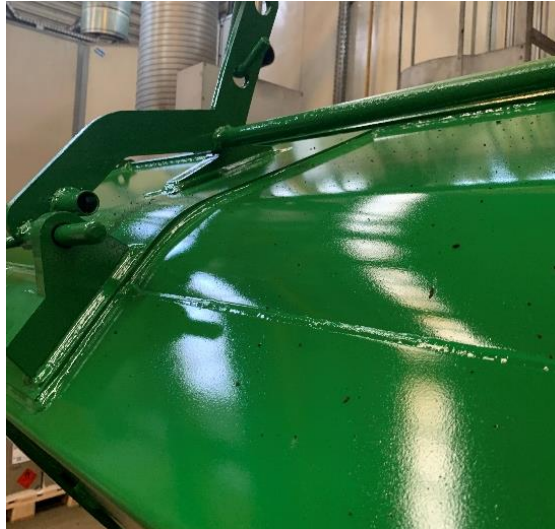
Figura 15 - Sujidade proveniente dos bastidores oxidados na peça a repintar
