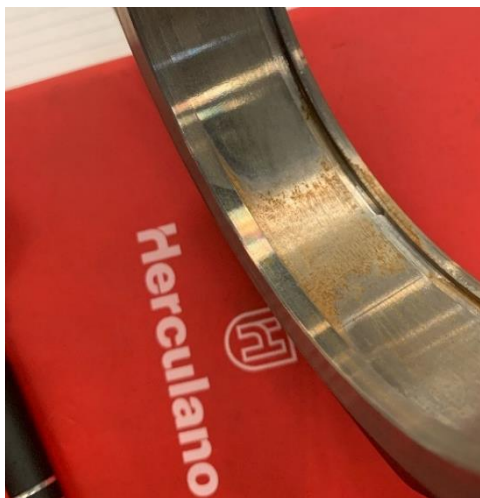
Figura 50 - Oxidação nos braços de carga John Deere
