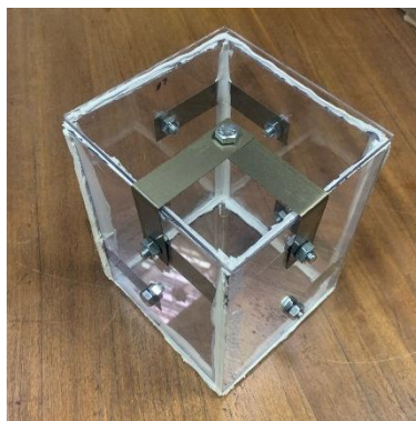
Figura 21 - Caixa para proteção da câmara
