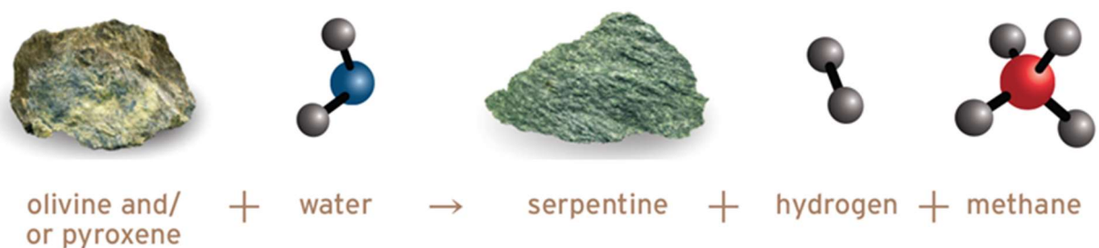
Figura 7|Processo de serpentinização e reação de Fischer-Tropsch.
