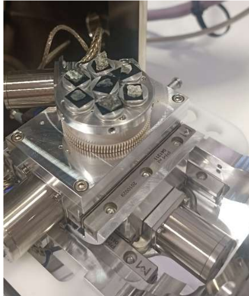
Figura 28|Revolver do microscópio eletrônico de varrimento carregado com fragmentos das amostras.
