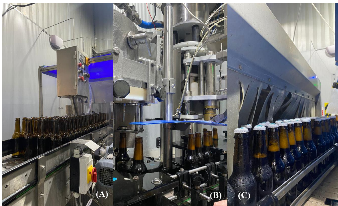
Figura 14 – Etapas da colocação das garrafas (A), enchimento (B) e da entrada no pasteurizador (C).
