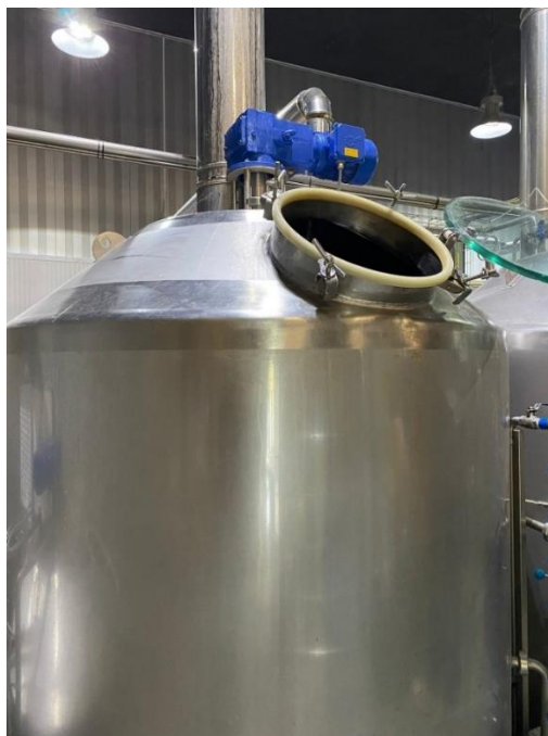
Figura 13 – Equipamento de brassagem onde é realizada a mistura dos ingredientes que constituem a receita da bebida concebida.
