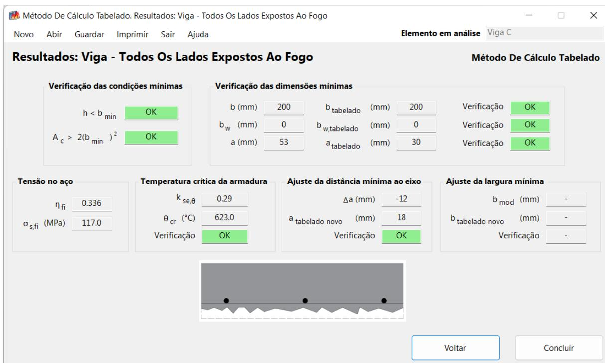
Figura 28. Exemplo de uma janela de resultados para o método de cálculo tabelado.
