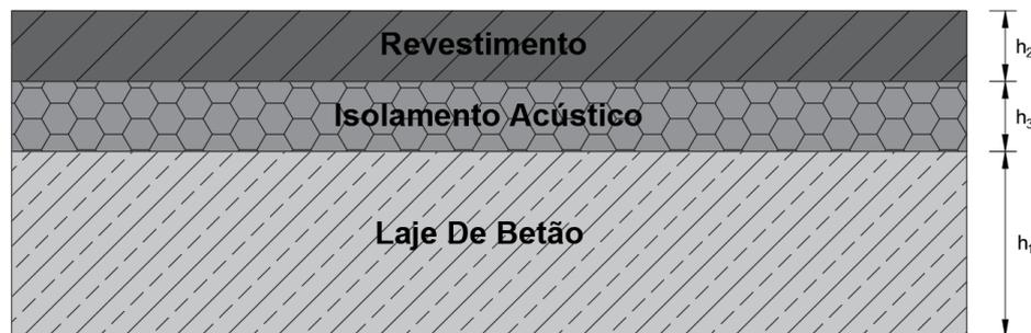
Figura 11. Laje de betão armado com isolamento acústico e revestimentos. Retirado e traduzido de CEN (2020).
