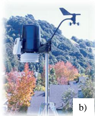
Figura 3-7-Dispositivos de medição da precipitação. a) pluviómetro; b) A Davis Weather Monitor II; c) Disdómetro (Thies laser precipitation monitor)
