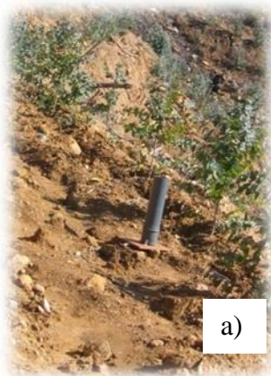
Figura 3-7-Dispositivos de medição da precipitação. a) pluviómetro; b) A Davis Weather Monitor II; c) Disdómetro (Thies laser precipitation monitor)
