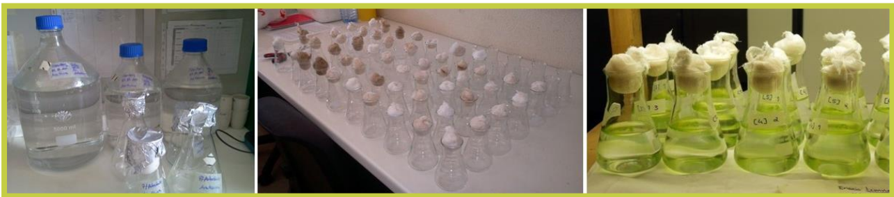
FIGURA 5: Exemplo do apparatus de um ensaio de inibição de crescimento em Lemna minor .
