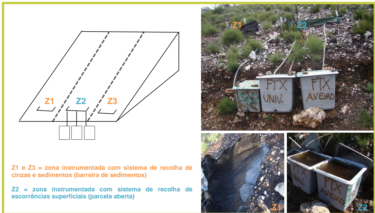
FIGURA 2: Sistema de recolha de cinzas e sedimentos (Z1 e Z3) e sistema de recolha de escorrências superficiais (Z2) instalados numa parcela ardida.
