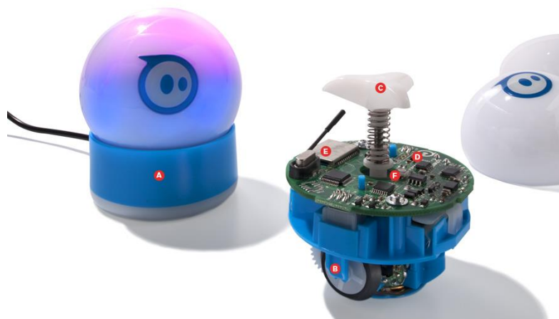
Figura 1. Componentes do Sphero: (a) base para carregar o Sphero; (b) rodas internas de borracha para locomoção do Sphero; (c) sistema de rolamento; (d) placa de Circuito; (e) bluetooth; (f) LED multicolor.
