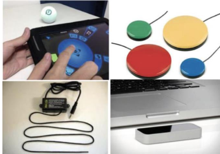
Figura 4: Exemplos de controles para o Sphero. Da esquerda para a direita: parte superior - Tablet e Switches; parte inferior - Push and click mouse e Leap Motion
