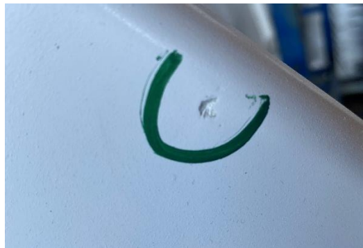
Figura 16 - Peça com defeito (crateras)
