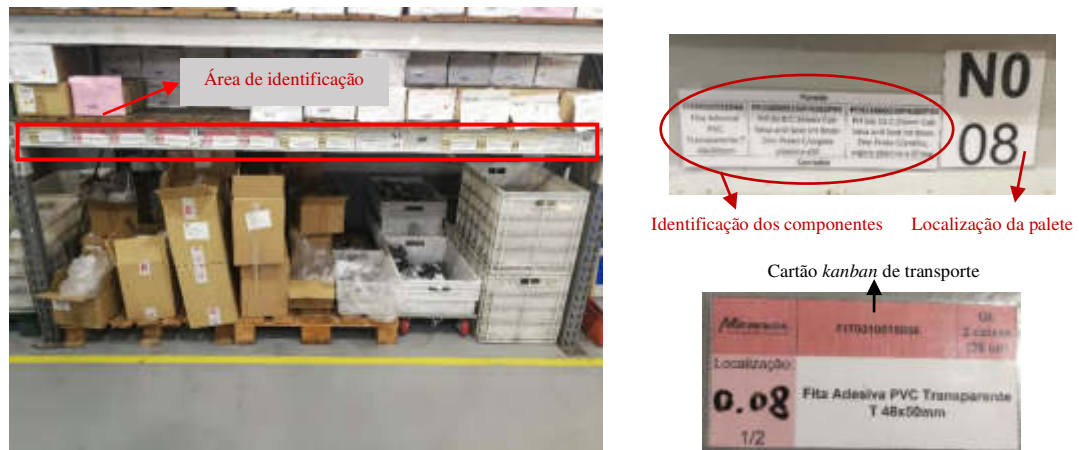
Figura 38 - Supermercado (depois), com etiqueta de localização da paleta, identificação dos componentes e um dos kanbans de transporte
