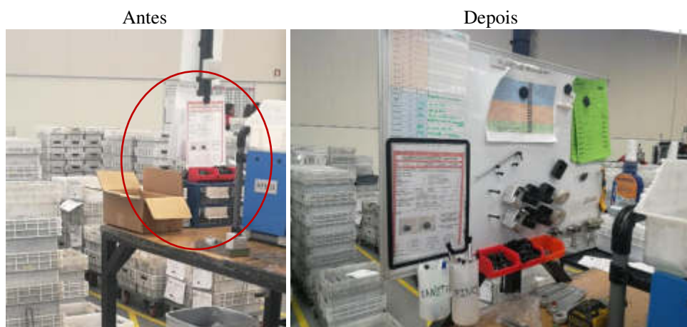
Figura 36 - Bancada de trabalho Tampa-saca (antes e depois)
