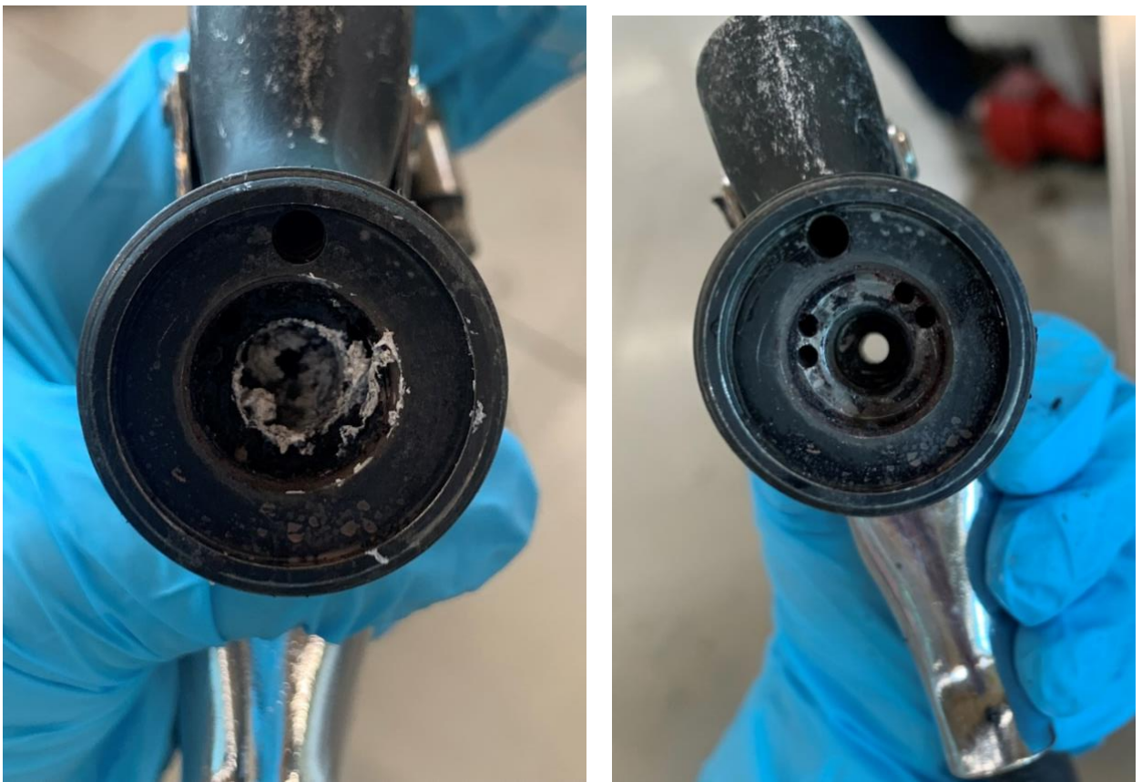
Figura 44: Pistola antes (esquerda) e depois (direita) de ser colocada na máquina ultrassons
