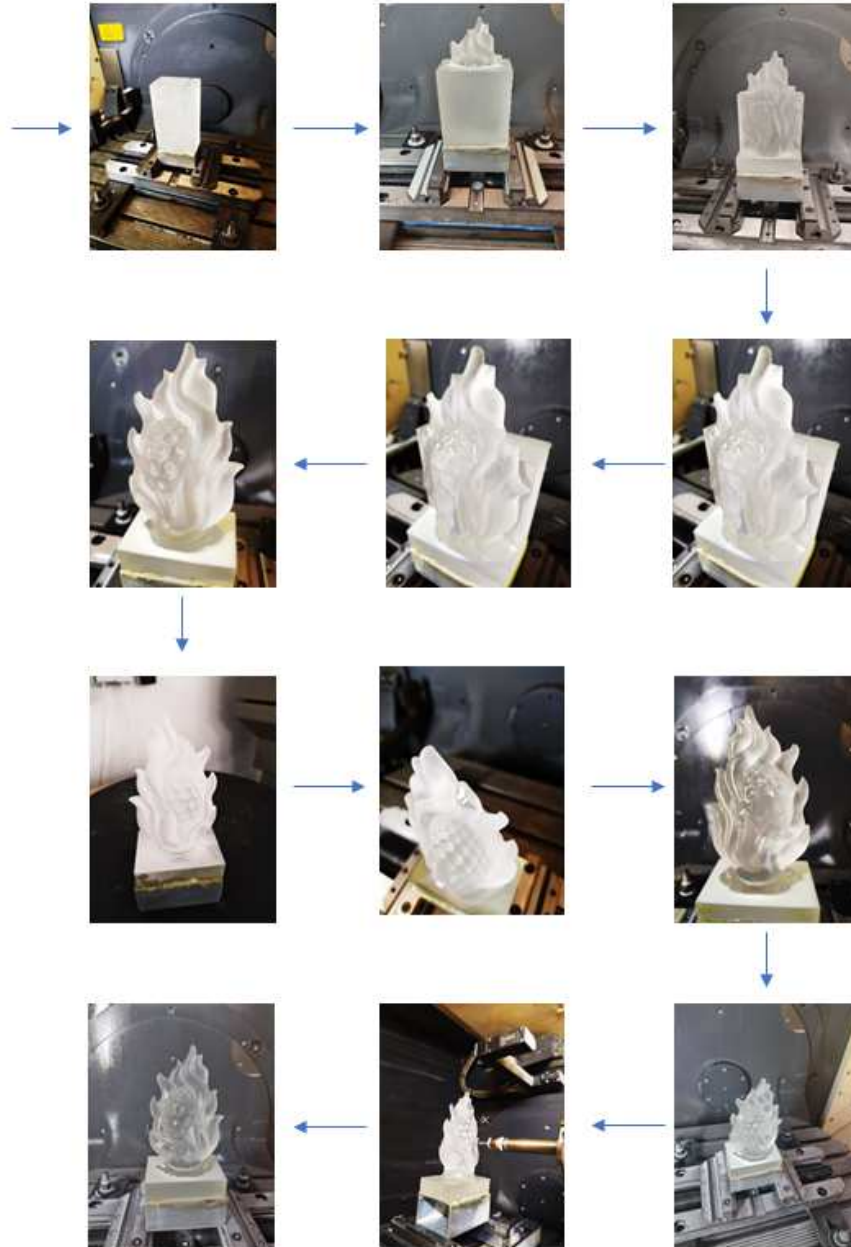
Figura 80 Sequência de maquinagem da escultura
