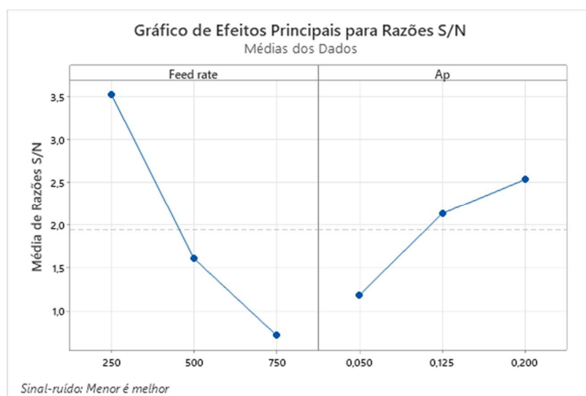
Figura 32 Gráfico Curva de S/N para cada parâmetro para rugosidade superficial Effgen20U
