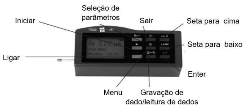
Figura 13 Esquema de funcionamento do rugosímetro Time TR220 [71]
