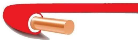
Figura 69: Fio condutor com secção circular
