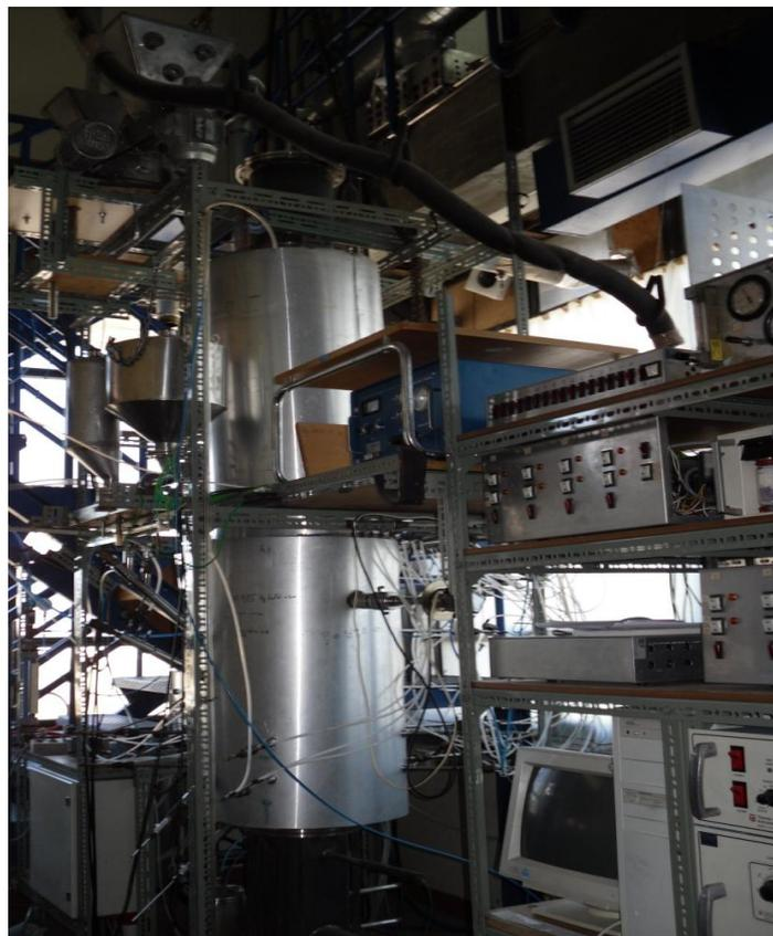
**Figura 4-1 – Sistema Experimental de combustão**
