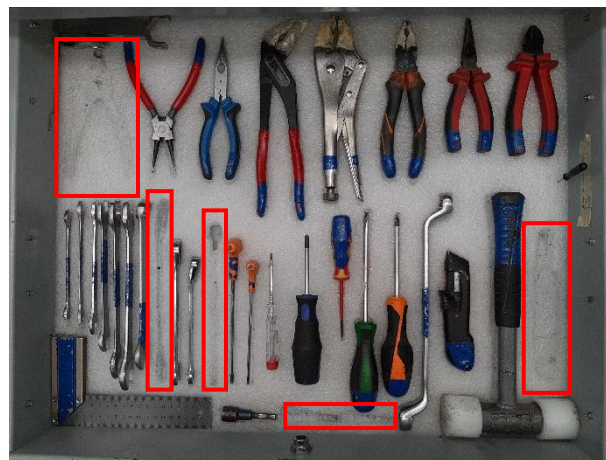
Figura 32: Gaveta de um posto de trabalho com ferramenta em falta.
