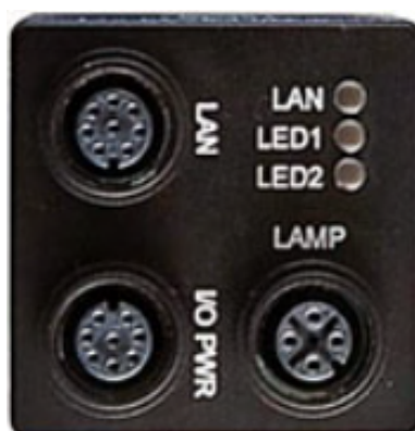
Figura 3.23: Parte de trás da BOA 1280×960 Mono SH Vision System
