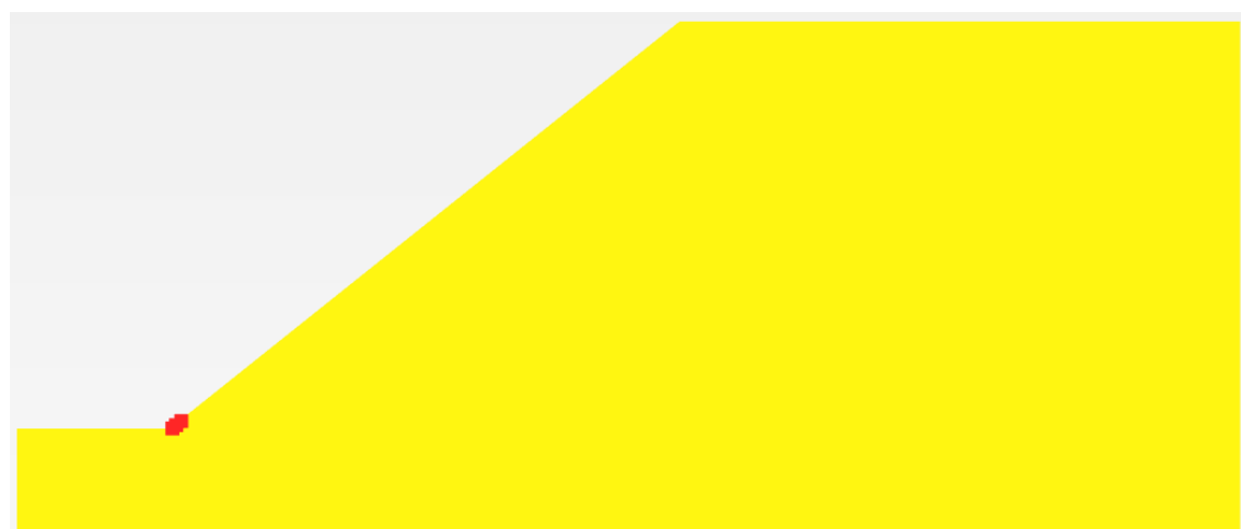
Figura 74. Pontos plásticos (vermelho) no modelo com 0,4 kPa [MN_NR_I_C04]
