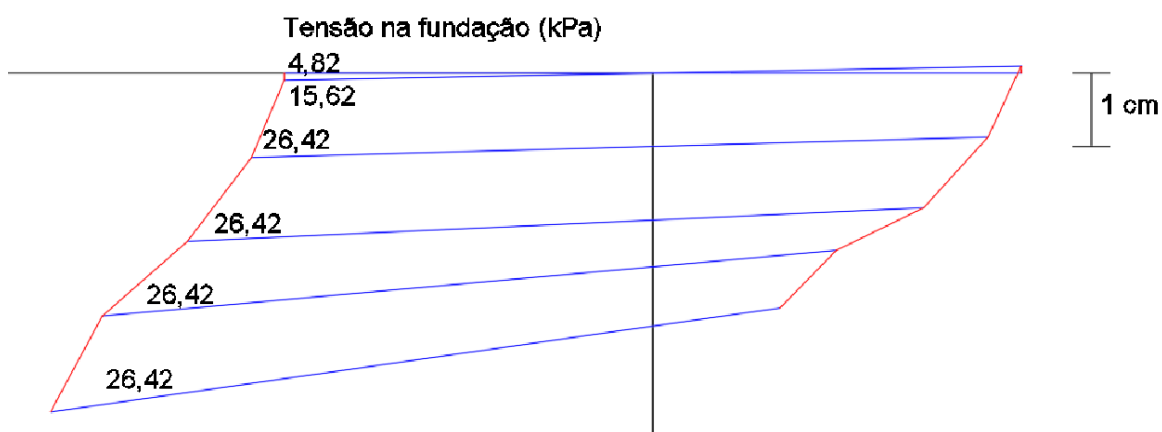
Figura 86. Posição da fundação (ou seja, o deslocamento total da fundação) para diferentes valores da sollicitação [MF_NR]
