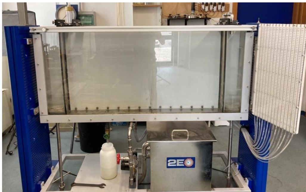
Figura 45. Caixa utilizada na construção e ensaio dos modelos físicos
