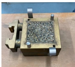
Figura 37. Preparação de uma amostra de solo solto para o ensaio de corte direto.
