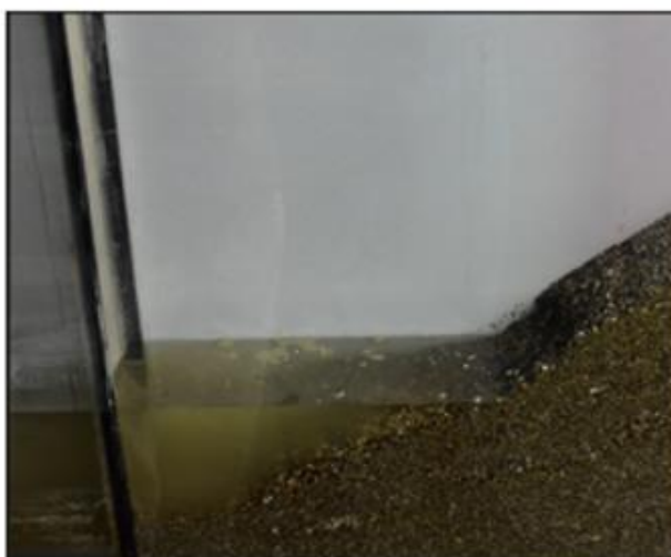
Figura 121. Rotura do talude [MF_NR_P] devido à percolação: a) vista lateral b) vista frontal/lateral
