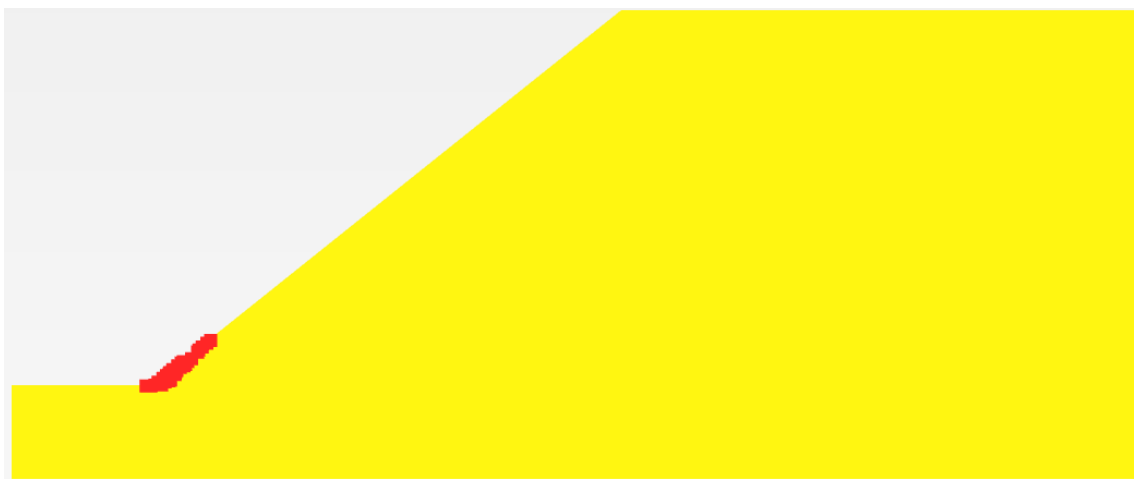
Figura 73. Pontos plásticos (vermelho) no modelo com 0,3 kPa [MN_NR_I_C03]
