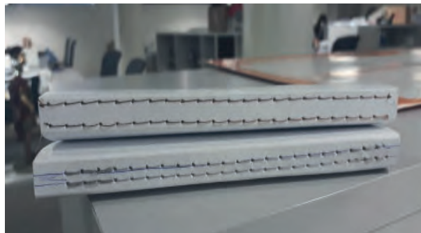
Fig. 1. Mockup produzido pela Gráfica 1, formato 14×20 cm, em papel vitopaper 232 g. Encadernação costura Singer, dupla.
