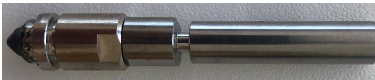
Figura 3.19: Nozzle 0.6 milímetros de diâmetro para altas temperaturas em aço temperado
