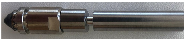
Figura 3.25: Nozzle 0.6 milímetros de diâmetro para altas temperaturas em aço temperado
