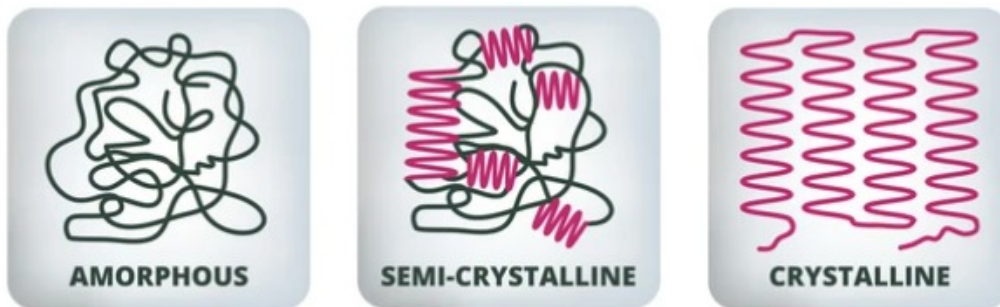
Figura 2.12: Tipos de Cristalização em polímeros (adaptado de [28])
