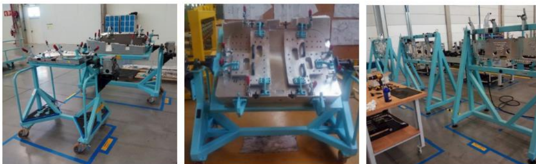
Figura 2: Gabaritos de montagem para o avião Legacy 450-500.
