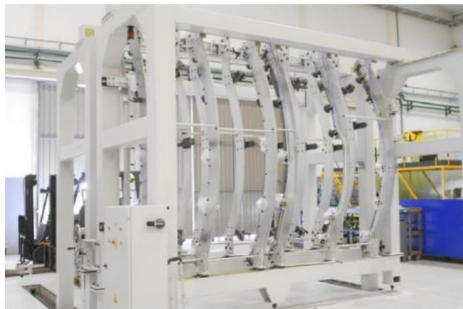
Figura 1: Gabarito de montagem da fuselagem central do avião KC-390.
