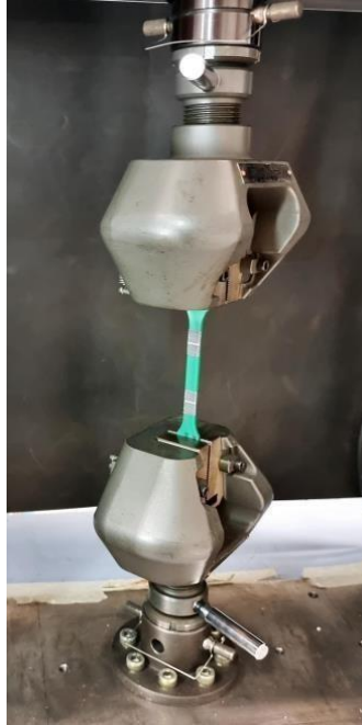
Figura 21. Exemplo de um ensaio de tração num dos provetes analisados.
