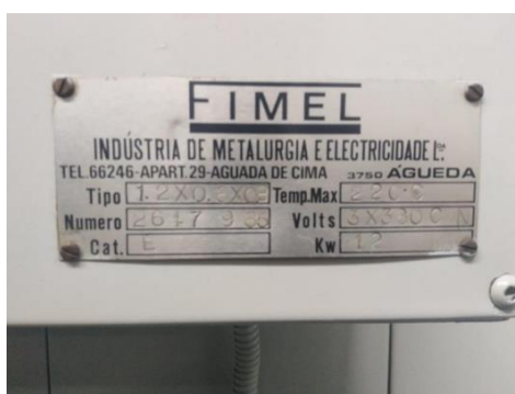
Figura 17. Especificações do forno.
