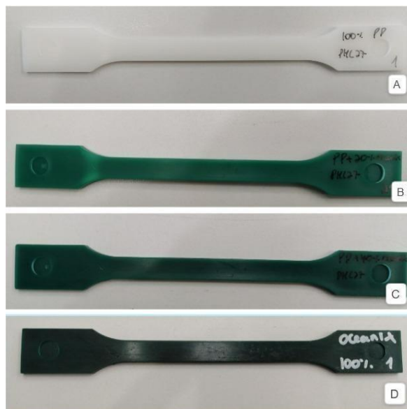
Figura 26. Provetes moldados por injeção: A) 100% PP; B) 80% PP/20% Oceanix; C) 60% PP/40%.; (D) 100% PP.
