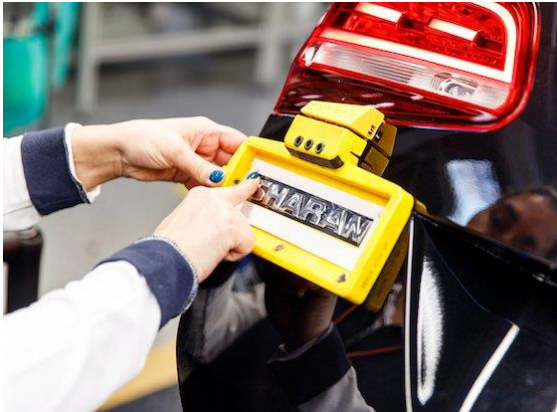
Figura 17- Jig produzido internamente na AutoEuropa, retirado de [69]
