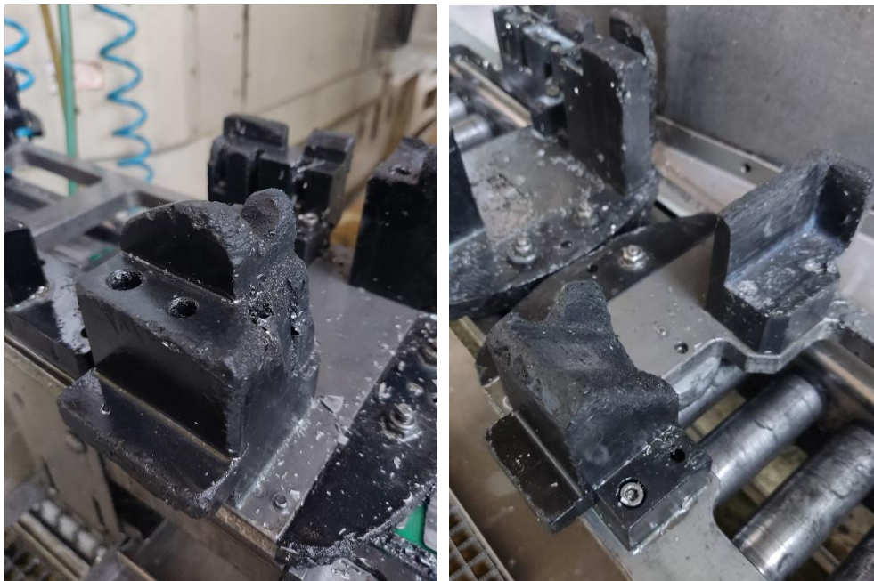
Figura 27- Peças em Ertalon® 66 GF30 desgastadas
