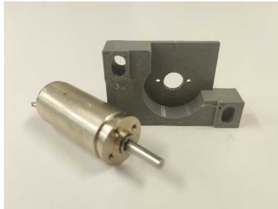
Figura 71- Apoio de motor feito em PLA
