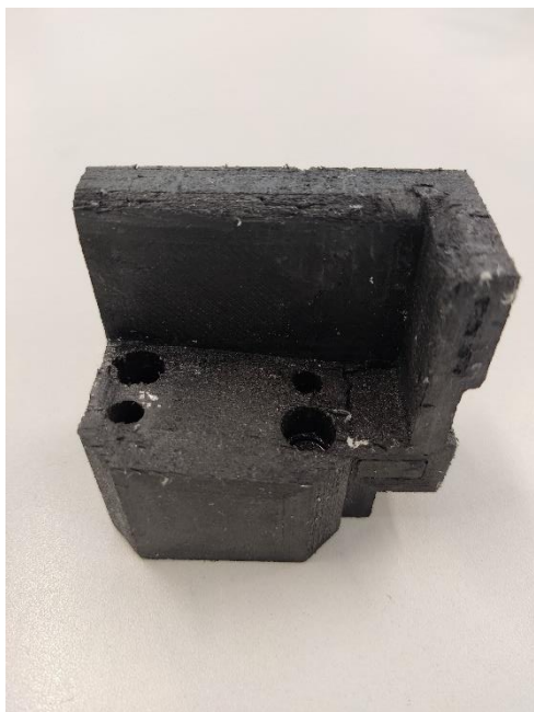
Figura 58- Peça em PAHT CF15 após um mês de utilização
