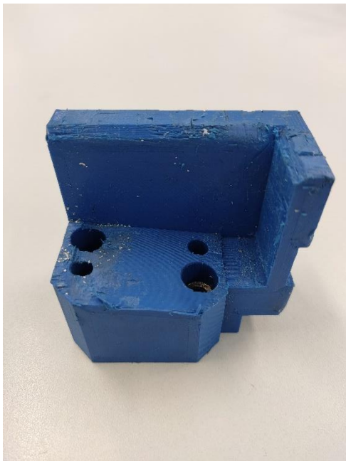
Figura 56- Peça em PETG após um mês de utilização
