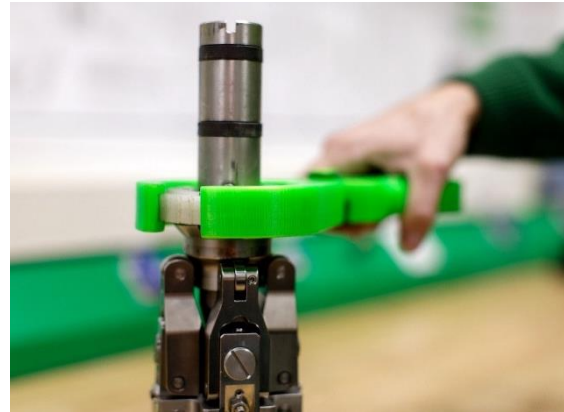
Figura 18- Ferramenta de aperto produzida pela Heineken, retirado de [70]
