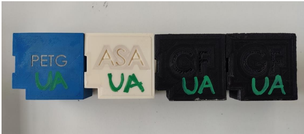
Figura 55- Peças fabricadas nos diferentes materiais e devidamente identificadas
