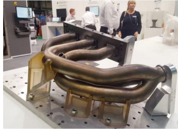
Figura 20- Jig para soldadura do sistema de escape do carro da Renault Sport Formula 1, retirado de [72]
