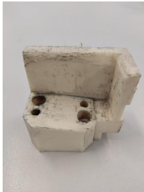
Figura 57- Peça em ASA após um mês de utilização
