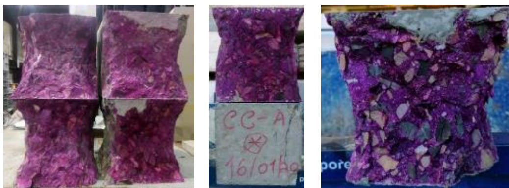
Figura 55. Controlo do grau de hidratação do betão.
