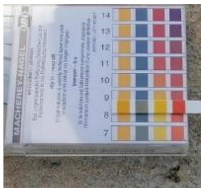
Figura 68. Medida de pH no betão pré-fabricado com cinza de cal e com filler natural.
