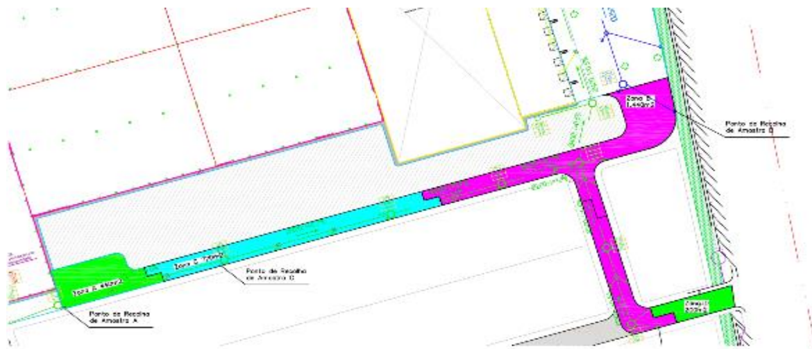
Figura 23. Planta de implementação do caso de estudo (verde -referência, azul - dregs e rosa - grits ).
