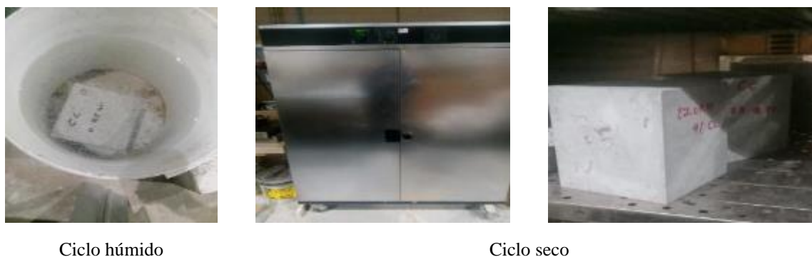
Figura 59. Controlo das eflorescências no betão.
