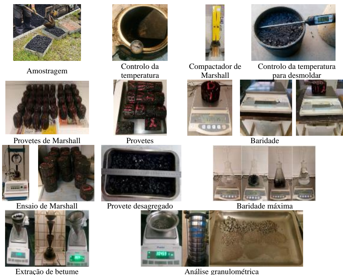
Figura 29. Controlo laboratorial sobre as misturas betuminosas.
