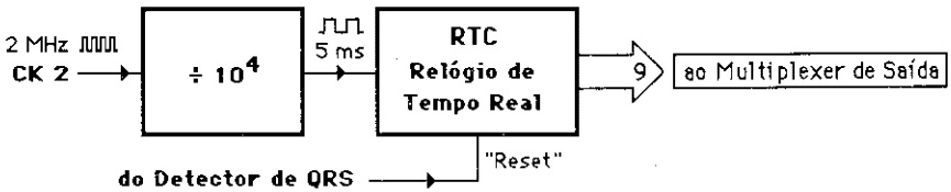
Fig. 3.18 - Relógio de Tempo Real, com uma resolução de 5 ms, reinicializado com a ocorrência de cada QRS. Este relógio mede o tempo, desde o último QRS, em que cada aquisição ocorre, e corresponde ao eixo dos xx do ecocardiograma modo-M.
