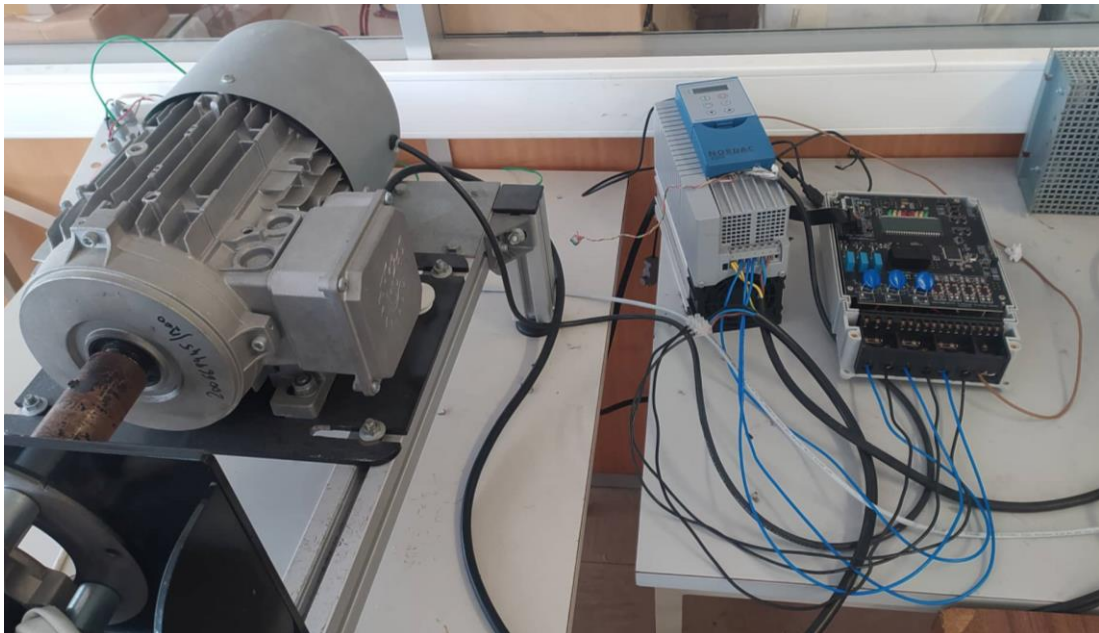
Figura 51 - Setup experimental para medição da tensão e corrente do motor.
