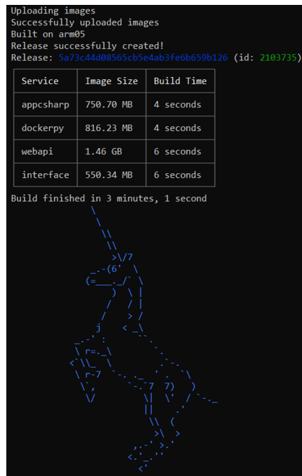
Figura 3.33: Comando balena “push” executado com sucesso.
