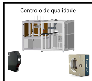
Figura 1.4: Célula de controlo de qualidade responsável pela identificação de defeitos nas peças.
