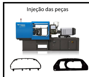
Figura 1.3: Máquinas de injeção responsáveis pela produção do front e rear frame .
