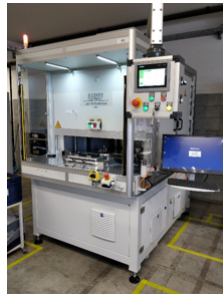
Figura 1.5: Equipamento de soldadura responsável pela união do rear frame e front frame .
