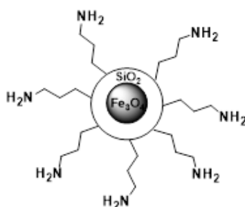
Figura 10 - NPs com núcleo de óxido de ferro magnético (Fe 2 O 3 ) revestido com uma camada de sílica funcionalizada com grupos aminopropilo.
