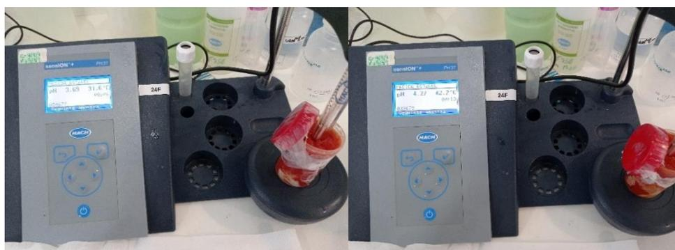
**Figura 14:** Medição do pH para a amostra 34 após incubação a  $37^{\circ}\text{C}$  e  $55^{\circ}\text{C}$  respetivamente.
