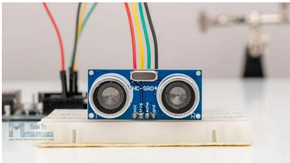
*Figura 49 - Sensor ultrassónico HC-SR04 [52]*
