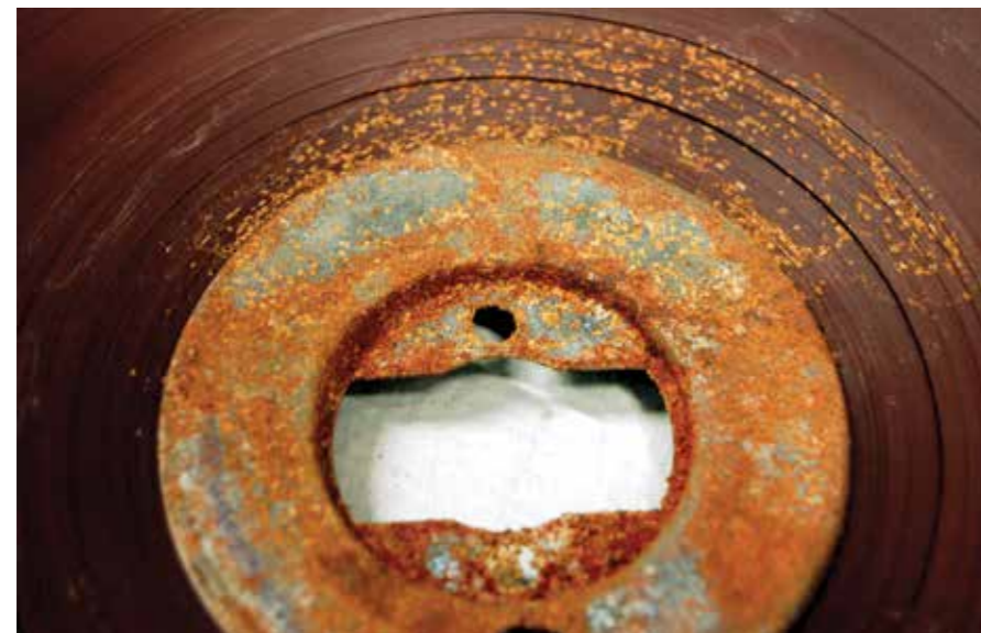
8 Efeitos da deterioração causada pela água: depósitos de corrosão no núcleo da bobina e na fita. Fotografia: Nadja Wallaszkovits. Effects of water damage: corroded deposits on the winding core and on the tape. Photo: Nadja Wallaszkovits.
