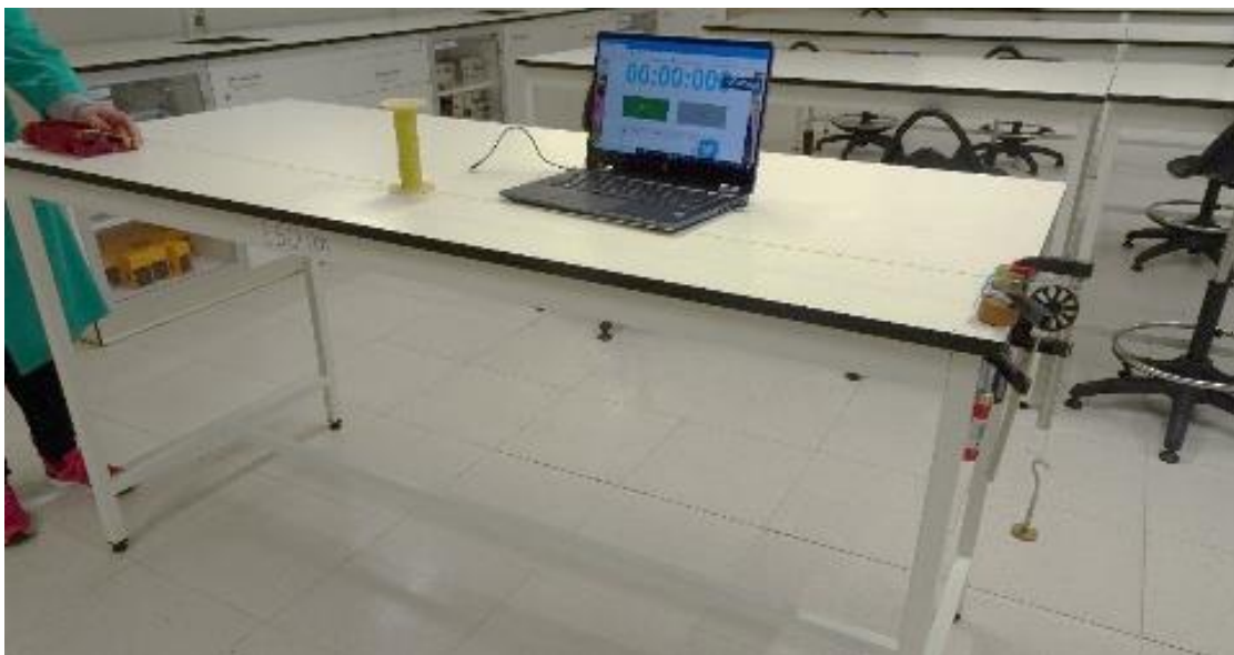
Figura 1. Movimento de um carrinho num plano horizontal ligado por um fio a um corpo que cai na vertical.
