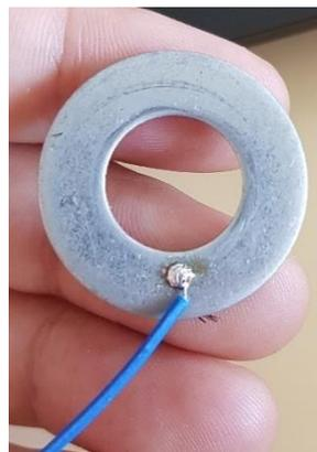
Figura 33 - Soldagem de cabo na anilha
