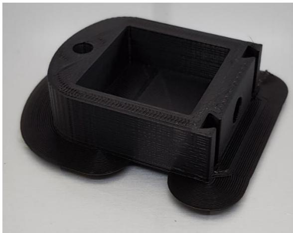
Figura 46 - Resultado final da impressão 3D da caixa inferior
