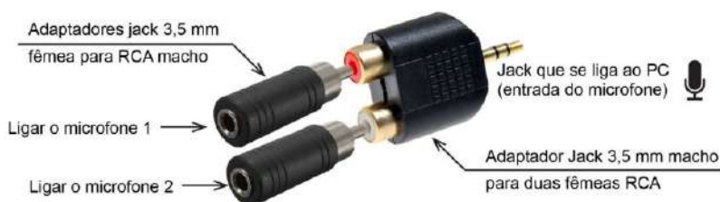
Figura 1 – Sistema de cabos áudio de 3,5 mm.
