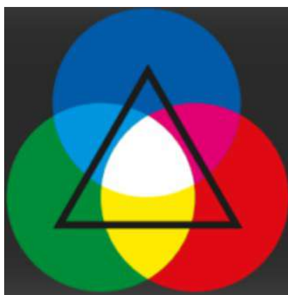
Figura 1 – Modelo aditivo com as cores primárias da luz.
