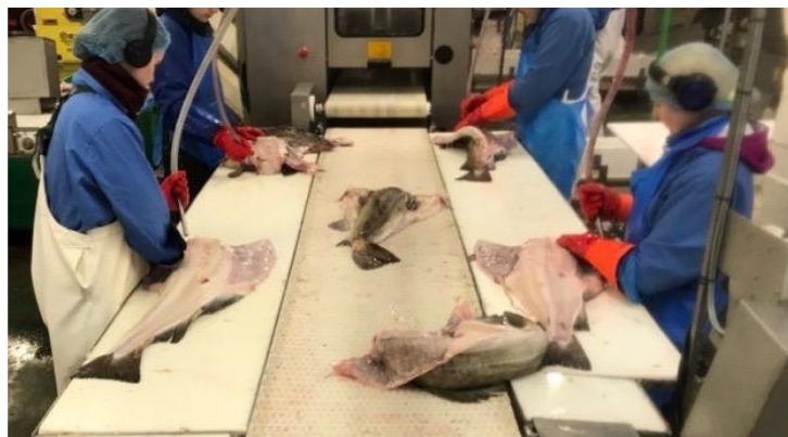
Figura 28: Limpeza ao bacalhau com o auxílio de aspiradores. (Autoria: Pedro Pinto, autor desta dissertação).
