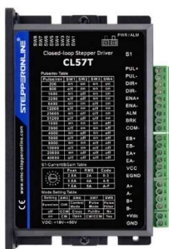
Figura 34 – Controlador de motor de passo CL57T 32
