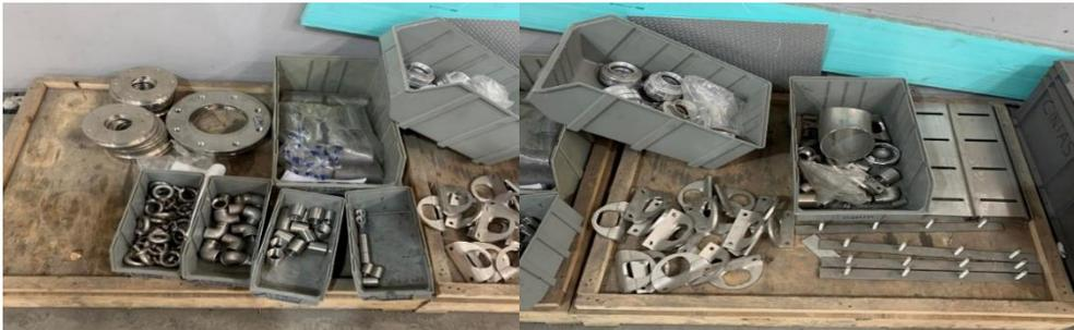
*Figura 23 - Acessórios fornecidos pelo armazém necessários à construção dos tanques de água da JMO.*
