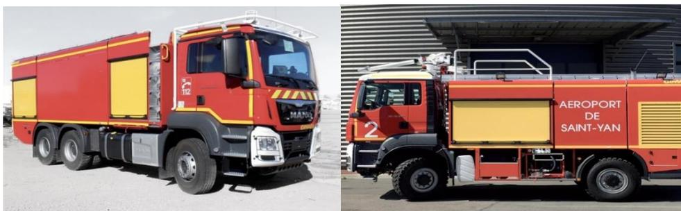
*Figura 11 - Veículo de espuma de alta potência e veículo de intervenção de espuma da Gimaex, com tanques de água em resina de poliéster insaturado reforçado com fibra de vidro com capacidade para 9500L e 2900 litros, respetivamente (Giamex, Firefighting Vehicles, 2022-b).*
