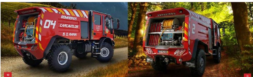
Figura 16 - Veículo VFCI 04, modelo Iveco ML 150 E28 WS e veículo VFCI 02, modelo Mercedes-Benz Atego 1330 AF da Tugafire. Equipados com um tanque em alumínio com capacidade de 3300 litros 3500 litros, respetivamente (Tugafire, Veículo Florestal de Combate a Incêndios, 2022-b).
