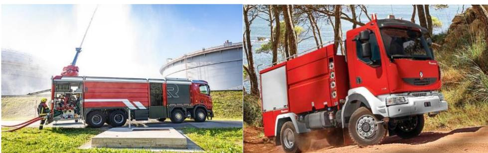
*Figura 3 - Modelo MT Industrial e Forest Firefighting Vehicles da categoria de veículos Industrial and Special. O primeiro está equipado com um tanque em polipropileno com capacidades que variam entre os 2000 e os 20000 litros e o segundo está equipado com um tanque de agente extintor, sistema de bomba e equipamentos de proteção (Rosenbauer, Industrial and Special Vehicles, 2020-b).*
