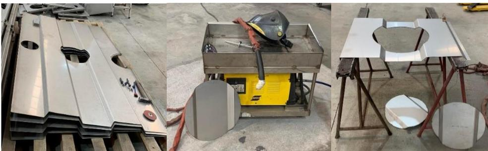
*Figura 24 - Processo de furação das chapas necessárias aos tanques da JMO de água através de corte por plasma.*
