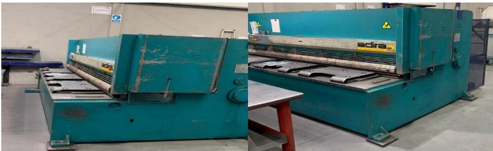
Figura 21 - Guilhotina utilizada para o corte das chapas dos tanques de água da JMO.
