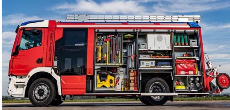
Figura 4 - Modelo AT (Advanced Technology) da categoria de veículos Municipais. Equipado com um tanque em polietileno com capacidades que variam entre os 500 e os 5500 litros (Rosenbauer, Municipal Vehicles, 2020-d).
