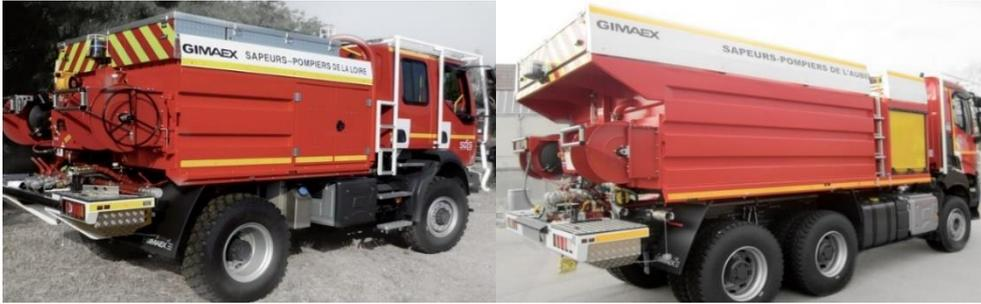
Figura 12 - Veículo caminhão-tanque de incêndio florestal e veículo super-caminhão-tanque de incêndio florestal da Gimaex, com tanques de água em aço inoxidável com capacidade de 3900 litros e 11450 litros, respectivamente (Giamex, Firefighting Vehicles, 2022-b).
