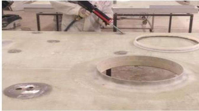
Figura 32 - Colagem de peças de inserção de aço inoxidável em painéis de parede em GRP usados num tanque de retenção de água de um veículo de bombeiros auto-portante (Limited, 2015).
