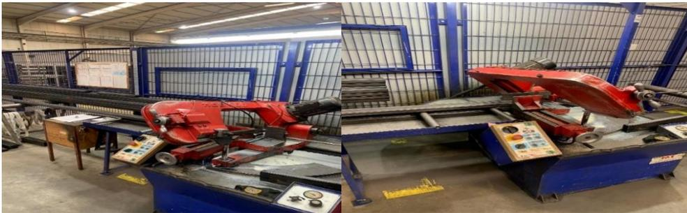
Figura 19 - Serrote utilizado na JMO para cortar os tubos necessários à construção do tanque.
