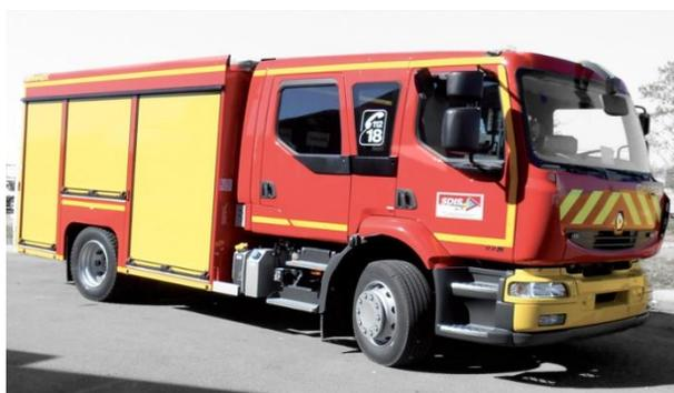
*Figura 10 - Veículo Renault de combate a incêndios da Gimaex, modelo veículo resgate rodoviário, com um tanque de água em polietileno com capacidade para 3050 litros (Giamex, Firefighting Vehicles, 2022-b).*
