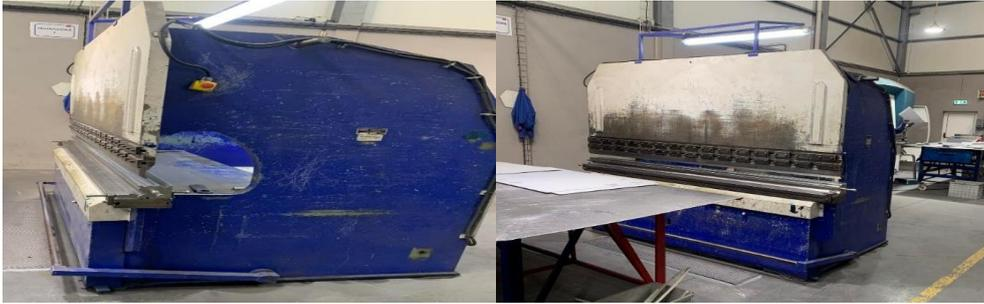
*Figura 22 - Quinadora utilizada para dobragem das chapas dos tanques de água da JMO.*
