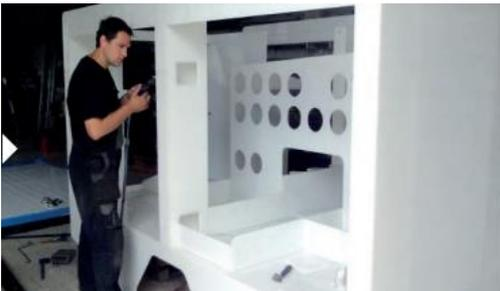
Figura 31 - As peças cortadas são quinadas e/ou soldadas por extrusão (Group, 2015).
