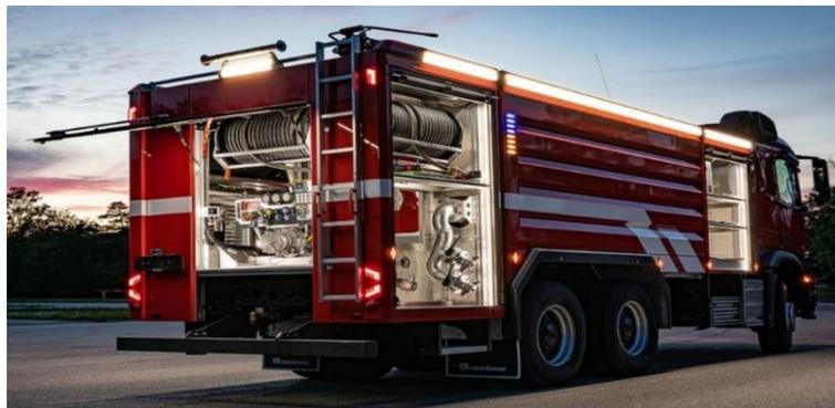
Figura 5 - Modelo MT Municipal (Modular Technology) da categoria de veículos Municipais. Equipado com um tanque em polipropileno com capacidades que variam entre os 2000 e os 20000 litros (Rosenbauer, Municipal Vehicles, 2020-d).
