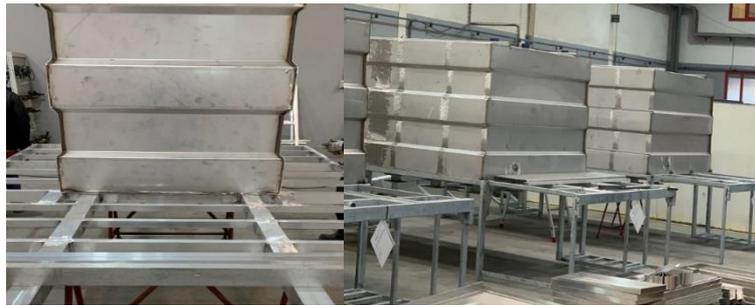
Figura 27 - Montagem dos tanques de água da JMO na superestrutura dos veículos a que se destinam.
