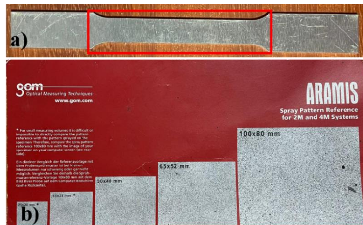
Figura 3.5. a) Provette para tração com zona assinalada a vermelho para pintura. b) Padrão de referência.
