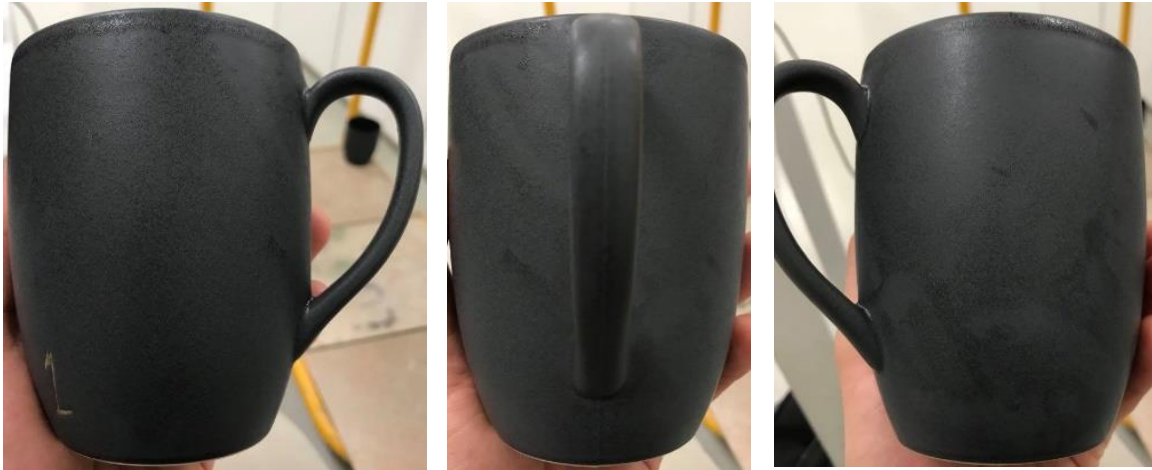
Figura 47 - Caneca após a cozedura do substrato seguida de cozedura do vidrado.
