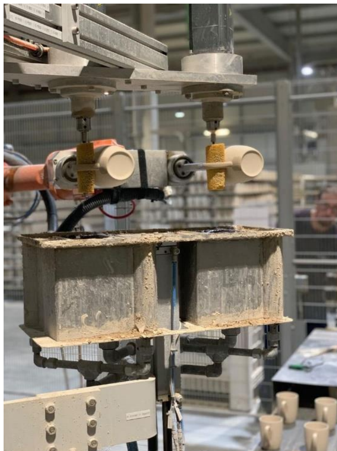
Figura 14 - Sistema de esponjamento automático das canecas.
