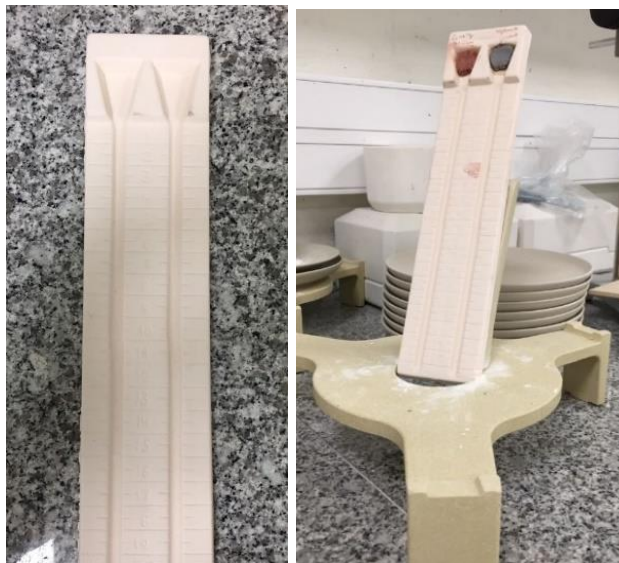
Figura 19 – Plano inclinado utilizado nos ensaios de fusibilidade dos vidrados.
