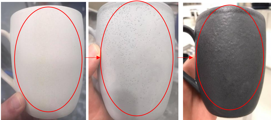
Figura 40 - Caneca B11 após raspagem da superfície (esquerda), após vidragem (centro) e após cozedura (direita). A linha a vermelho identifica a área em que foi realizada a raspagem.
