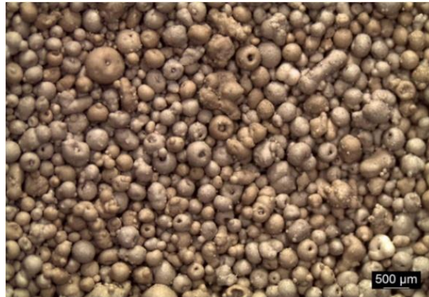
Figura 6 - Imagem de um granulado obtido por atomização [7].
