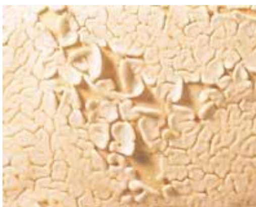
Figura 11 - Defeito de enrolamento do vidro [26].
