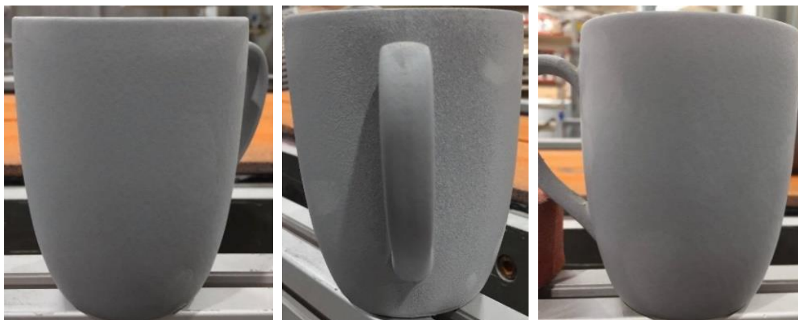
Figura 44 - Caneca B11 após vidragem por pulverização com o vidrado BS.
