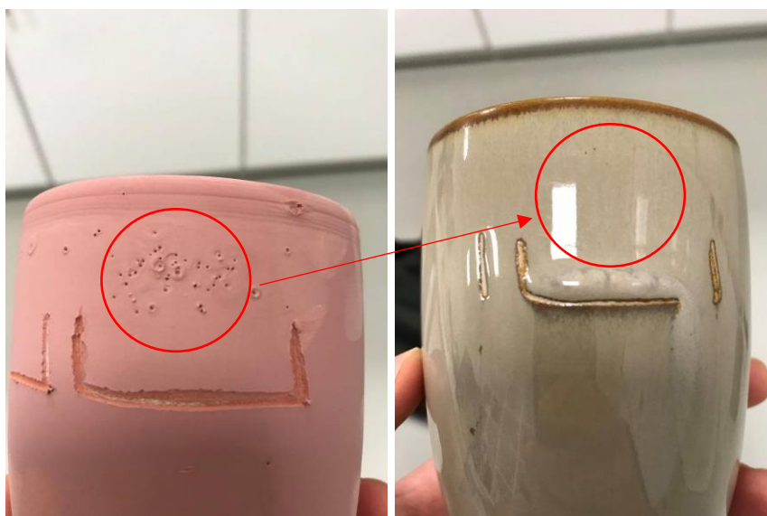
Figura 37 – Defeitos do tipo I após vidragem (esquerda) e após cozedura (direita) em canecas conformadas por prensagem isostática e vidradas por mergulho com o vidro GM.
