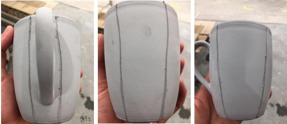
Figura 38 - Canecas B11 vidradas após pulverização com água nas áreas identificadas pelas marcas na superfície.
