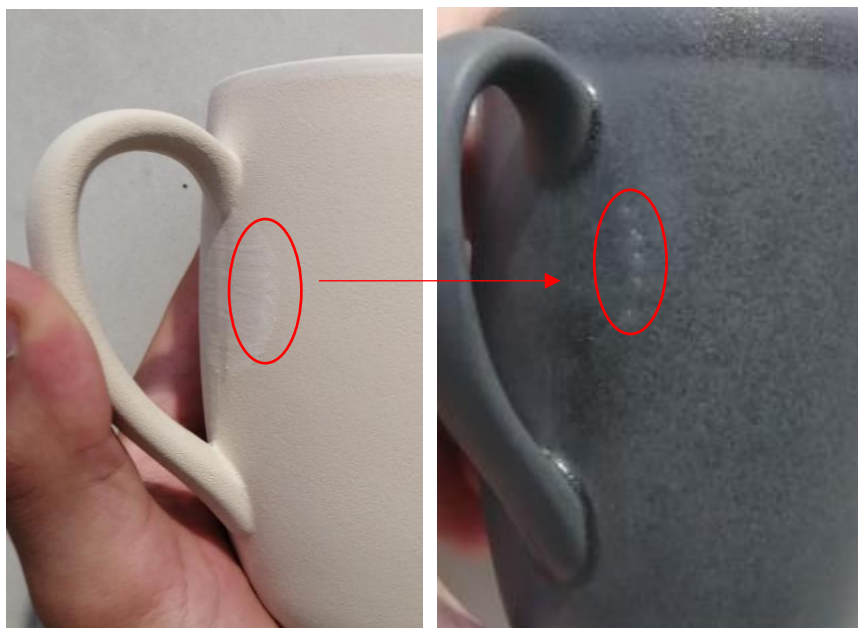
Figura 46 – Caneca pertencente ao segundo conjunto de peças, após o acabamento automático (esquerda) e após a cozedura (direita). Na zona desta última imagem delimitada pela linha a vermelho é possível observar vários defeitos do tipo II.
