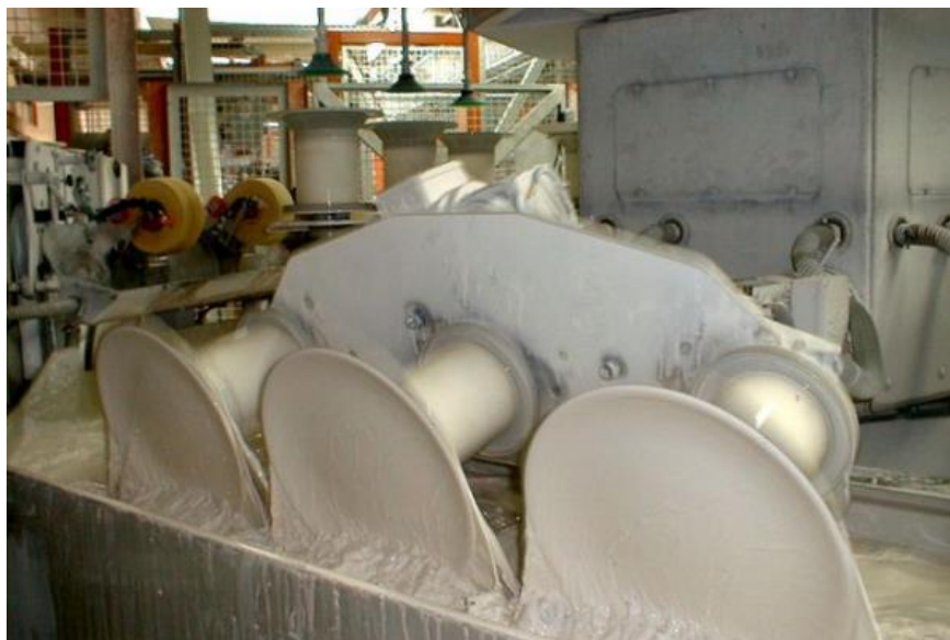
Figura 8 - Processo de vidragem de pratos por mergulho [21].
