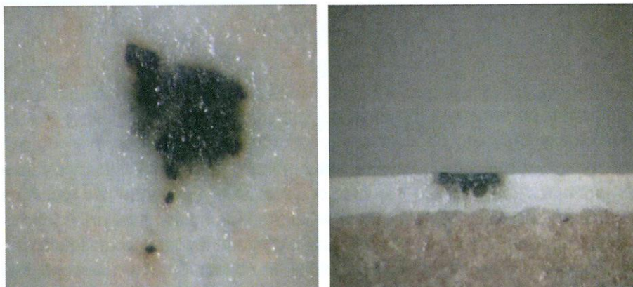
Figura 12 - Contaminação com partículas de ferro [13].
