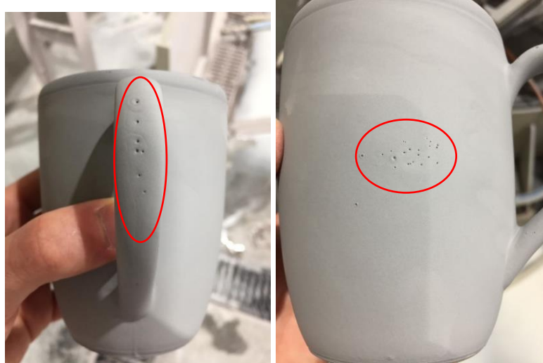
Figura 41 - Caneca B11 após a vidragem realizada de forma que o contacto com a suspensão de vidro ocorresse primeiro na zona da asa (esquerda) e na zona lateral (direita). A linha a vermelho identifica a área com maior incidência de defeitos.
