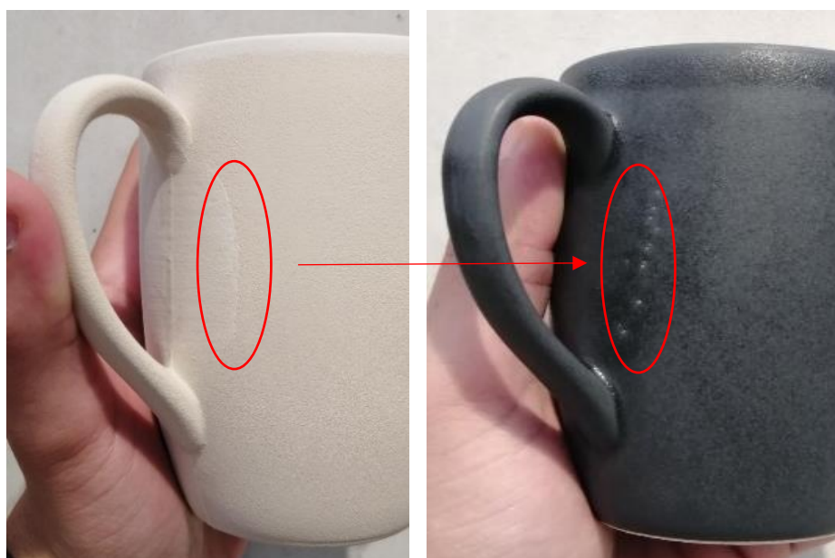
Figura 45 – Caneca após o acabamento automático (esquerda) e após a cozedura (direita). Na zona desta última imagem delimitada pela linha a vermelho é possível observar vários defeitos do tipo II.
