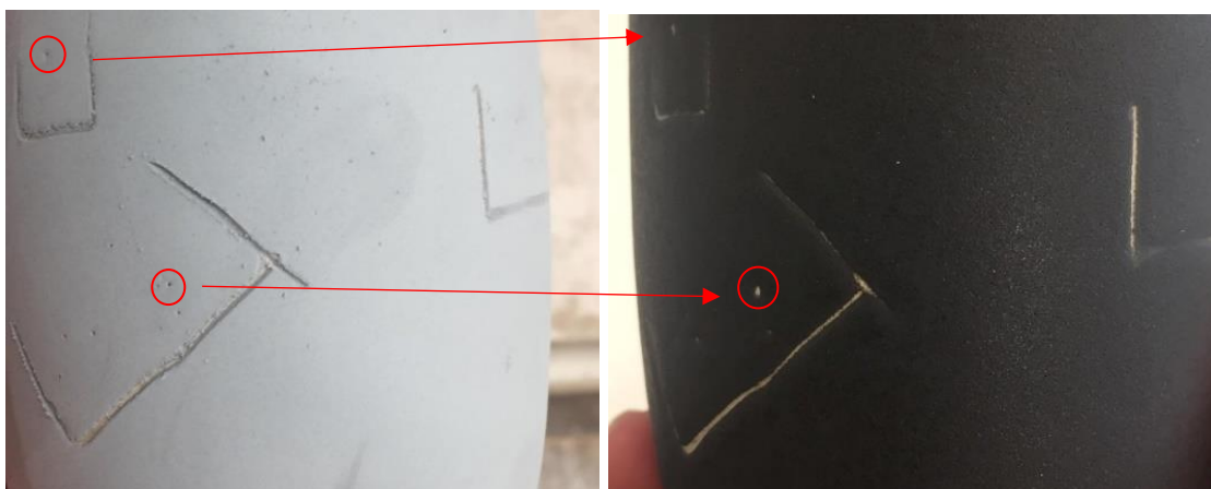
Figura 36 – Defeitos do tipo I após vidragem (esquerda) e após cozedura (direita) em canecas conformadas por prensagem isostática e vidradas por mergulho com o vidro BS.
