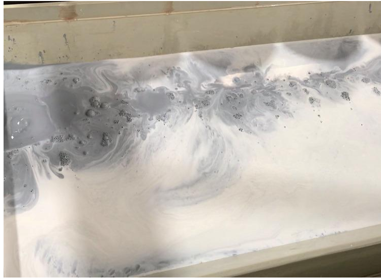
Figura 42 –Aspecto da suspensão de vidro na cuba do equipamento Mono de vidragem automática por mergulho.
