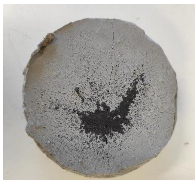
Figura 41: Ilustração do aparecimento de fissuras no bi-corpo com uma camada densa de 2mm.
