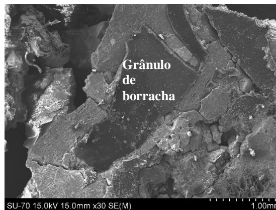
Figura 34: Imagens de MEV do compósito geopolimérico contendo 90% de borracha.
