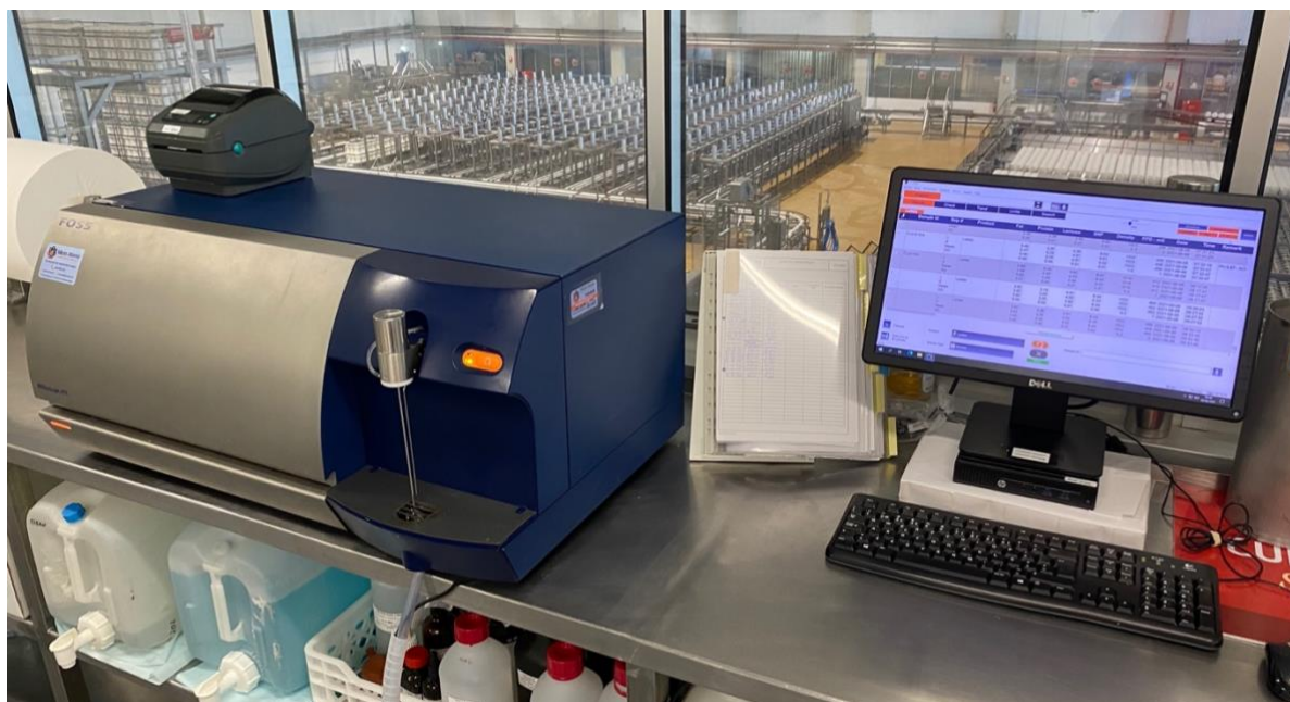
Figura 28 – Dispositivo de leitura das características do leite, FT1
