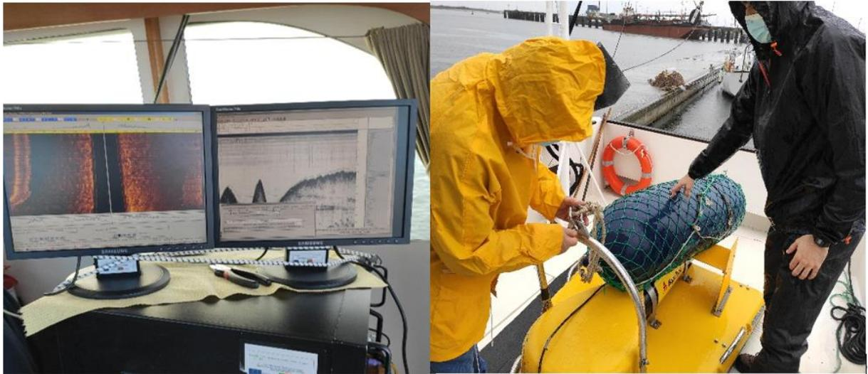
Figura 13. Sistema integrado Edgetech 512i, que combina um sistema Chirp Sonar e um sistema de sonar de varrimento lateral.
