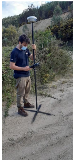
Figura 4-5. Medições em campo dos pontos de controlo.
