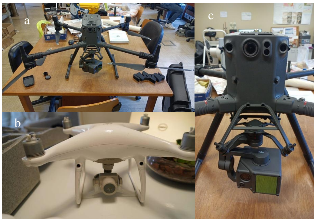
Figura 4-2. Drones utilizados no trabalho. a) DJI Matrice 300; b) DJI Phantom 4 Pro; c) Detalhe do sensor Lidar DJI L1.
