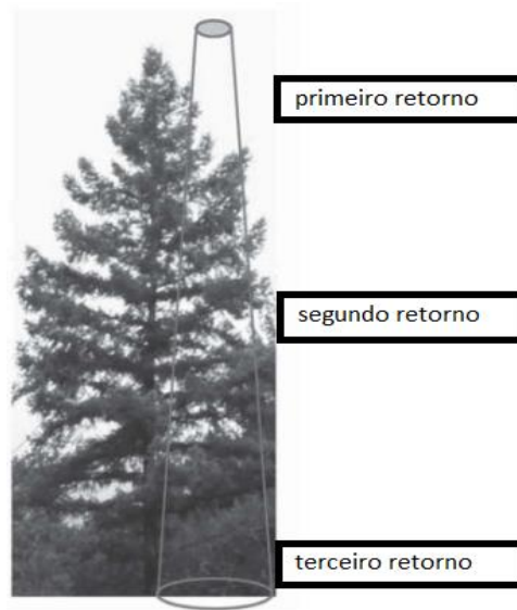
Figura 3-3. Representação dos múltiplos retornos que um pulso laser pode obter em vegetações (adaptado de Pinliang & Chen, 2018, p.20).
