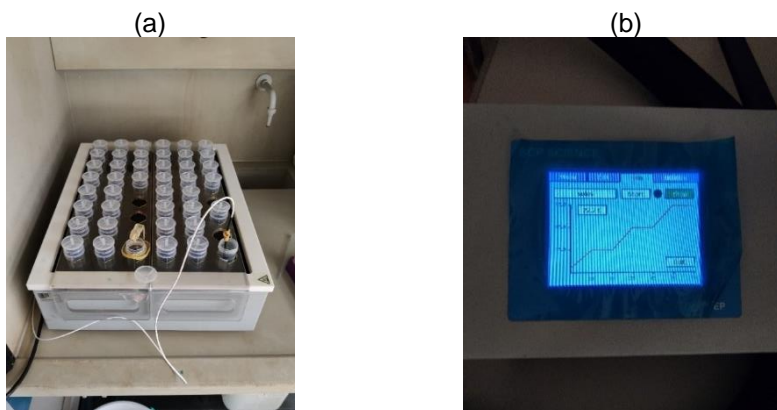
Figura III. 12: (a) Bloco de digestão química; (b) Patamares temperatura e tempo usados na digestão.
